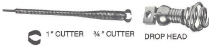
**5/16" Cable Multiuso con Alma Interior.** Diseñado para limpiar líneas de lavabos y fregaderos de 1-1/4" a 1-1/2", y para trabajos ligeros en líneas de 2". Contenido: cuchilla de 3/4" de ancho, cuchilla de 1" de ancho, cabezal de bajada
